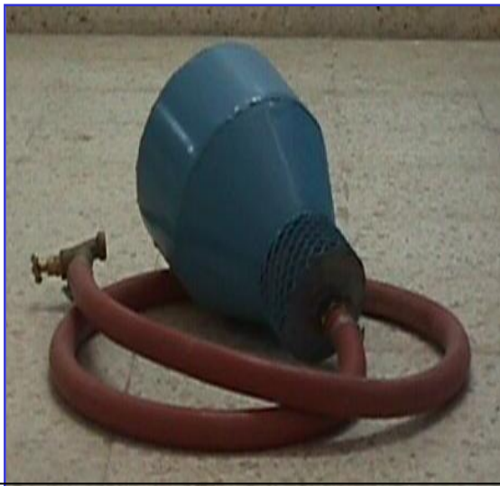
Flotteur drainant gravitaire pour l'exhaure et la distribution des eaux stockées dans les réservoirs (en maçonnerie) souterrains dans les régions montagneuses
