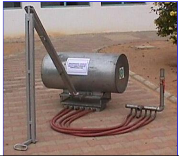
Flotteur drainant gravitaire utilisé pour l'exhaure et la distribution des eaux des petites retenues (1000 à 10 000 mètres cubes)
